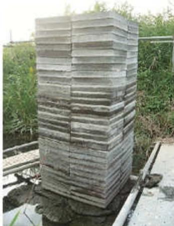
写真3 沼地（深さ約2mのヘドロ層）載荷試験でのD・BOX上のコンクリート平板の積層状態
