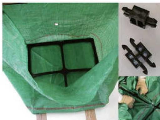
写真4 ガイドゲージがD・BOXにセットされた状況
