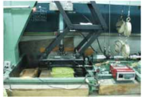
写真-1 実物土のう積層体の大型繰返しせん断試験機
