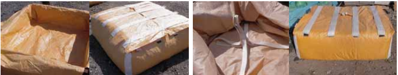
1) トラスバンド無の内部と中詰材投入後の形状 2) トラスバンド有の内部と中詰材投入後の形状
